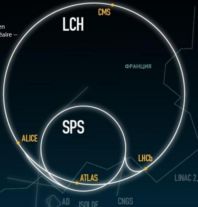
**LCH** Большой адронный коллайдер (БАК). Открыт 10 сентября 2008 года и остается последним дополнением к ускорительному комплексу ЦЕРН. БАК состоит из кольца сверхпроводящих магнитов с рядом ускоряющих структур для повышения энергии частиц
